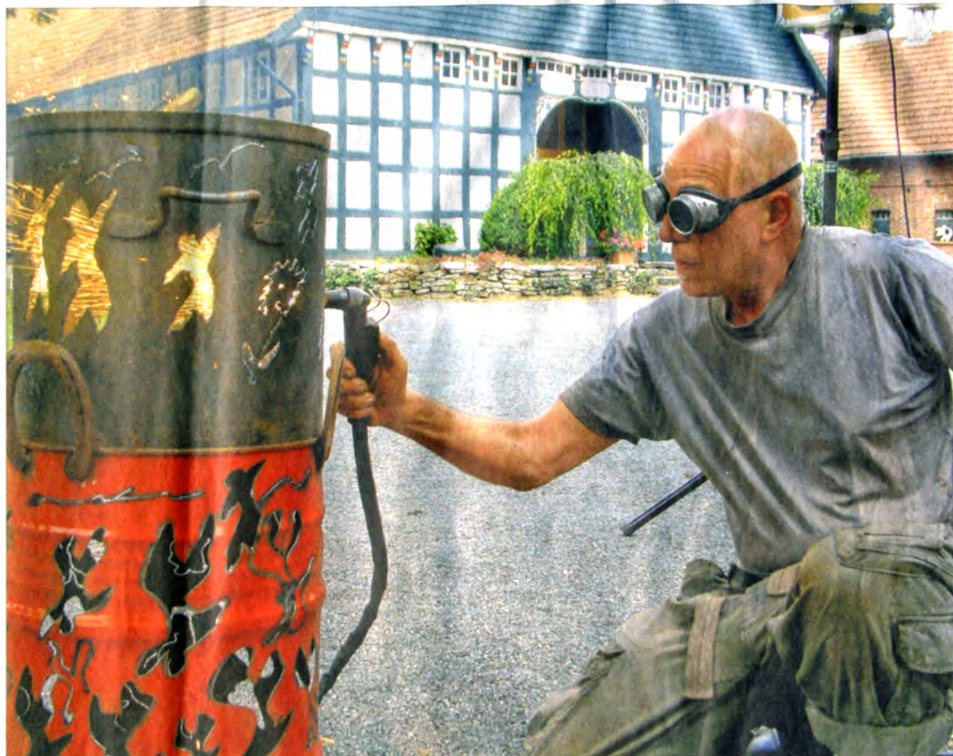
Mit Starkstrom und Pressluft funktioniert die Plasma-Schneiderei. Wenn Jonathan loslegt, sprühen die Funken.
